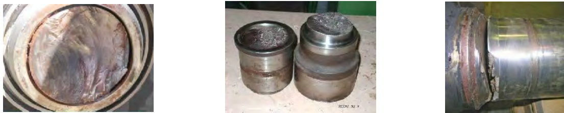
Рис. 1. Втомні злами осі внаслідок розвитку втомної тріщини в шийці
