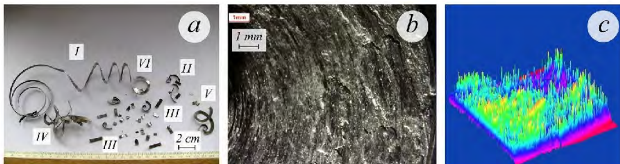
Рис. 1. Продукти різання з високонікелевої сталі, отриманні при швидкості різання 315 об/хв, подача 0,2 мм/об при додаванні води в зону різання. Зовнішній вигляд продуктів різання (стружка) – а; поверхня різання – б; комп'ютерна візуалізація поверхні різання – с
