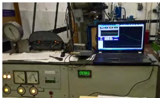
Рис. 2. Інформаційний пристрій з підключеним адаптером і програмним забезпеченням OBD
